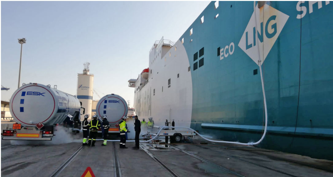
El sistema MTTS permite un suministro simultáneo de varios vehículos cisterna.
